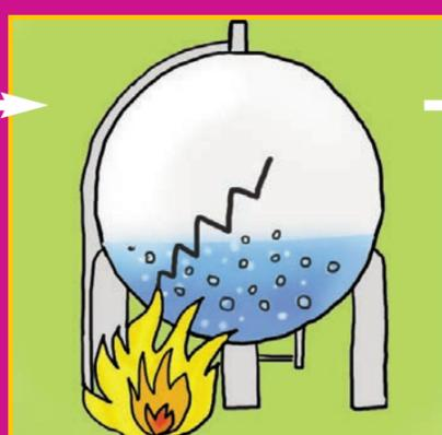
La pression devient trop forte. La paroi fragilisée par la chaleur se fissure : la pression chute.
